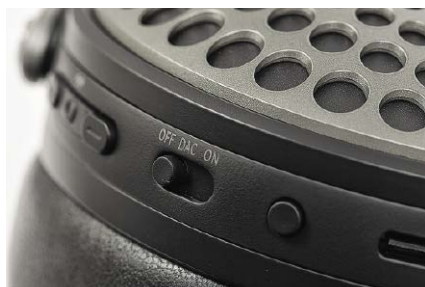
Włącznik zasilania ma dodatkową pozycję DAC, uruchamiającą wejście cyfrowe USB
